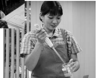
吉田三千代氏 野菜の硝酸値をFQフレックスで簡易分析しているところ ▼
